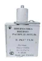
Трехлинейные пневмораспределители предназначены для изменения направления потоков сжатого воздуха в пневматических приводах и системах управления. Пневмораспределители типа П-РК3 двухпозиционные, трехлинейные, нормально закрытые, клапанные распределители с ручным, механическим и пневматическим управлением.
