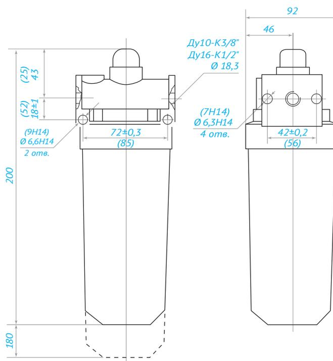
Условный проход (06, 10, 16 мм) X X X X X 4 Вид присоединительных отверстий:
