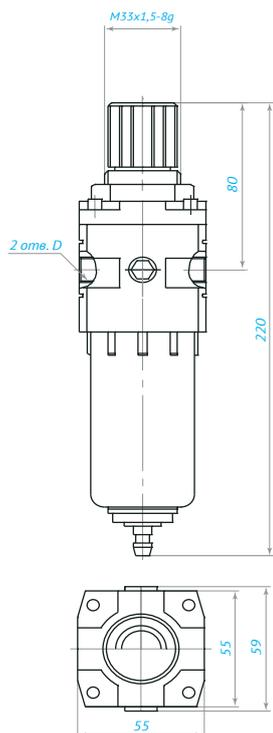
Модульное устройство П-МК04 (Dy 10; 16)
