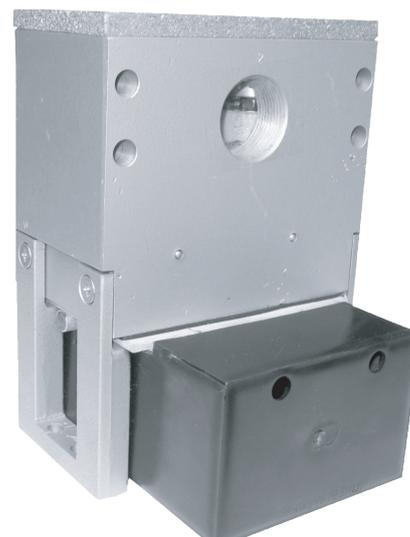
Пневмораспределители трехлинейные сдвоенные с односторонним электропневматическим управлением, пневматическим возвратом и ручным дублированием управления предназначены для изменения потока сжатого воздуха в пневмоприводах кузнечно-прессовых и других машин, имеющих одноручные, двуручные или педальные системы управления.
